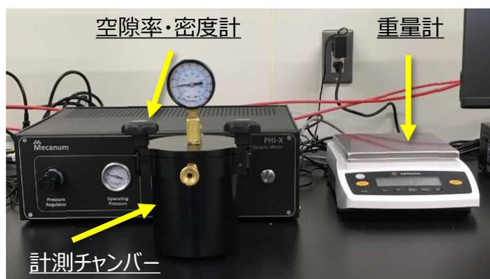
$$\text{空隙率 } \varphi = \frac{\text{空隙部分の体積}}{\text{全体の体積}}$$
